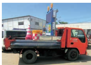
2t車、電光盤、 防音型発電機
