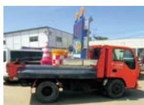
2t車、電光盤、 防音型発電機
